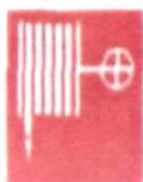
F 02 Пожарный кран
