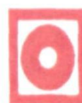
F 10 Кнопка включения установок пожарной автоматики
